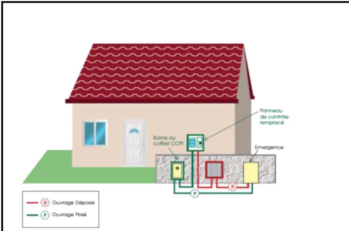
Déplacement branchement complet souterrain - Raccordement depuis une boîte sur réseau avant et après travaux
